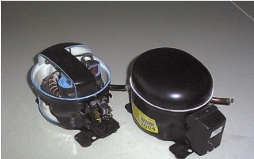
Bild 3: Ein Kompressor mit Schnittmodell
