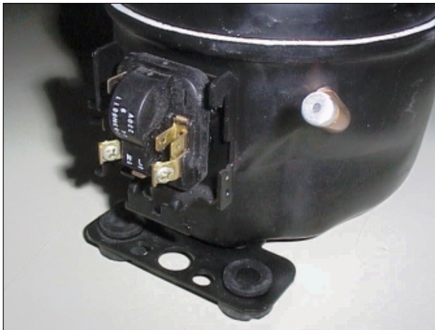
Bild 7: Kompressor mit Anschweißteil für die Aufnahme der Elektrik
