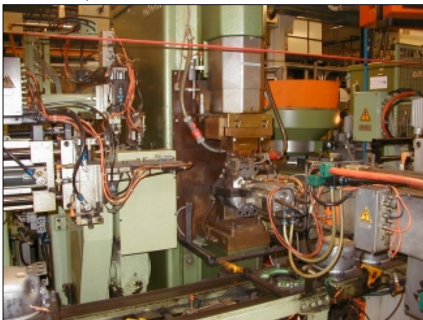
Bild 14: Anlage zum Buckelschweißen des Elektrohalters
